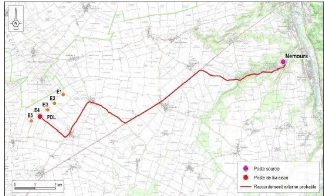
Figure 7: Tracé potentiel du raccordement électrique externe du parc au réseau public (étude d'impact, p. 229)
